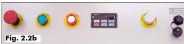
Presione el botón verde para aplicar potencia al controlador y a los motores. (figura 2.2c )
