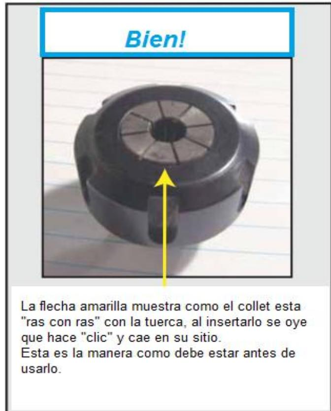
**No empuje o presione el “collet” contra el cabezal de corte (“Spindle”).**
